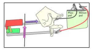
Der zu beiden Fingern senkrecht ausgestreckte Mittelfinger zeigt die Richtung der Lorentzkraft an. In diesem Fall nach rechts.
