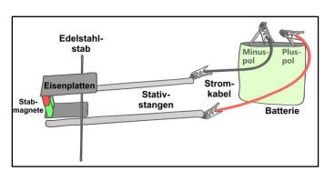
Die Eisenplatten nehmen das Magnetfeld der Stabmagnete auf. Dadurch entsteht ein Hufeisenmagnet.
