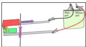
Mithilfe der Drei-Finger-Regel der linken Hand kann man wieder die Richtung der Lorentzkraft bestimmen. Der Daumen der linken Hand zeigt in die Richtung, in der die Elektronen durch den Edelstahlstab fließen.
