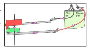
Wir interessieren uns wieder nur, in welche Richtung die Elektronen durch den Edelstahlstab fließen. In diesem Fall fließen die Elektronen quasi in das Bild hinein.
