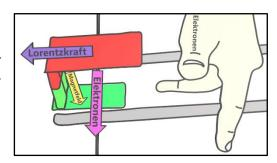
Der senkrecht dazu ausgestreckte Zeigefinder zeigt die Richtung des Magnetfeldes an, also in Richtung des Südpols.
