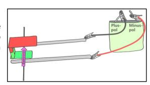
Das Magnetfeld zeigt vom Nordpol zum Südpol des Hufeisenmagneten.
