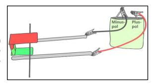
Die Elektronen fließen vom Minuspol der Batterie, über die hintere Stativstange, durch den Edelstahlstab, über die vordere Stativstange in den Pluspol der Batterie.
