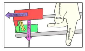
Der zu beiden Fingern senkrecht ausgestreckte Mittelfinger zeigt die Richtung der Lorentzkraft an. In diesem Fall nach links.
