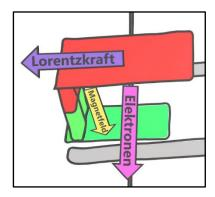
Mithilfe von drei Fingern der linken Hand, kann man die Richtung der Lorentzkraft bestimmen. Der Daumen der linken Hand zeigt in die Richtung, in der die Elektronen durch den Edelstahlstab fließen.
