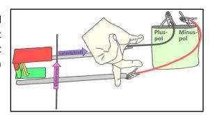
Der senkrecht dazu ausgestreckte Zeigefinder zeigt die Richtung des Magnetfeldes an, also in Richtung des Südpols.
