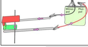
Wir interessieren uns nur, in welche Richtung die Elektronen durch den Edelstahlstab fließen. In diesem Fall fließen die Elektronen quasi aus dem Bild heraus.
