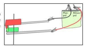
Die Elektronen fließen vom Minuspol der Batterie, über die vordere Stativstange, durch den Edelstahlstab, über die hintere Stativstange in den Pluspol der Batterie.
